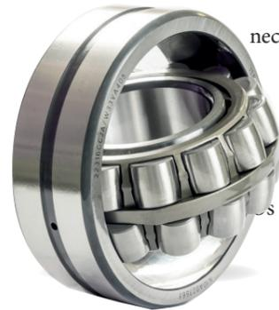
O formato das pistas permite o livre desalinhamento angular do anel interno dentro da pista esférica do anel externo, conferindo ao rolamento a característica de autocompensation. Isso possibilita sua aplicação em situações onde é necessário compensar deflexões do eixo e/ou desalinhamentos dos mancais. Os anéis internos podem ser produzidos com furos cilíndricos ou cônicos. Os rolamentos autocompensadores de rolos de todas as séries dimensionais estão disponíveis com furo cilíndrico.
